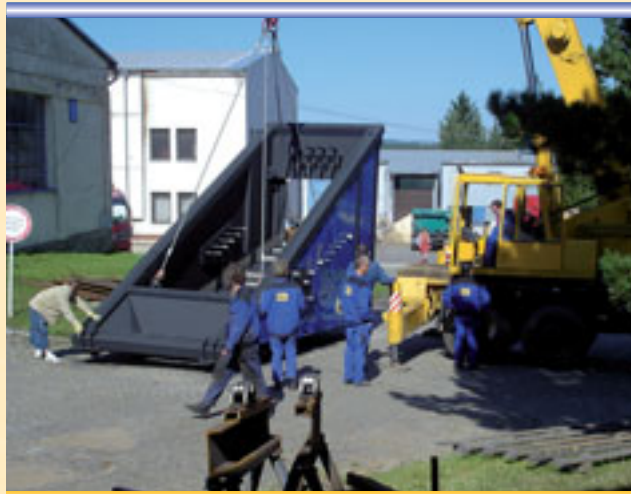
Roštová časť kotla VESKO-B pri ceste k zákazníkovi
