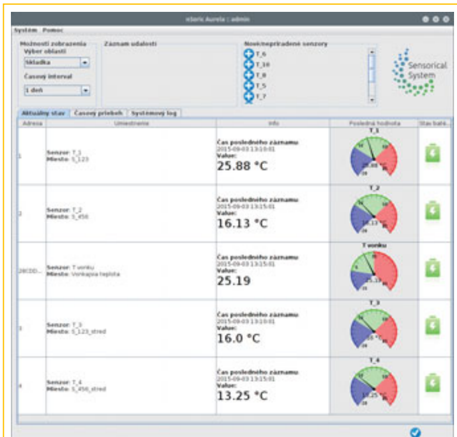
Obr. 2 – SW Aurela: zobrazenie aktuálnych teplôt a záznam teplôt za posledný deň
